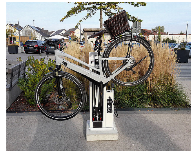
Abb. 75 Beispiel für eine öffentliche Fahrradreparaturstation, Quelle: www.oberasbach.de
