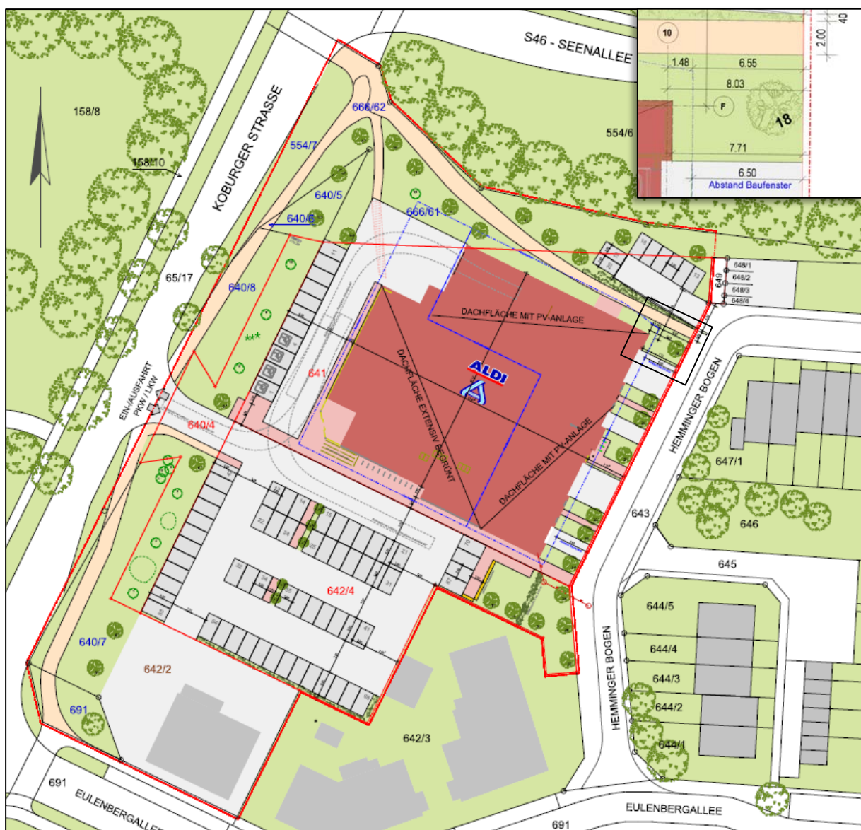
Abb. 1: Städtebaulicher Entwurf vom 14.10.2022 (Ingenieurbüro Stamm) Kastendarstellung: Bemessung des Abstands der Baugrenze zur Grundstücksgrenze mit geplanter Bebauung
